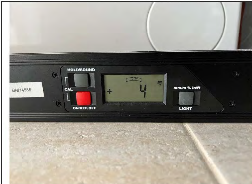
Фото №25. Измерение уровня напольного покрытия в ванной комнате.
