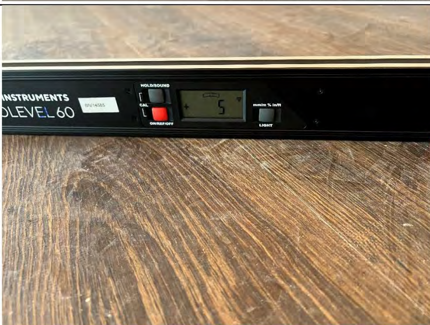
Фото №21. Измерение уровня напольного покрытия в коридоре.
