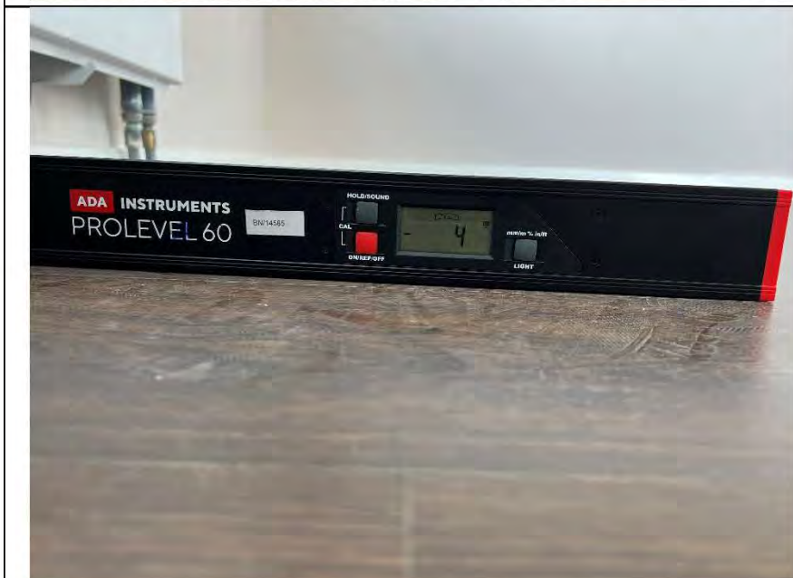
Фото №23. Измерение уровня напольного покрытия в спальне.
